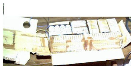
La pile BA-48 ouverte . Les éléments ne sont pas récupérabl s
