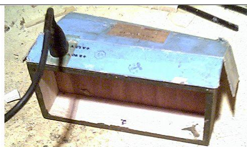
Vérification du positionnement du cordon en sortie de pile BA-48.
