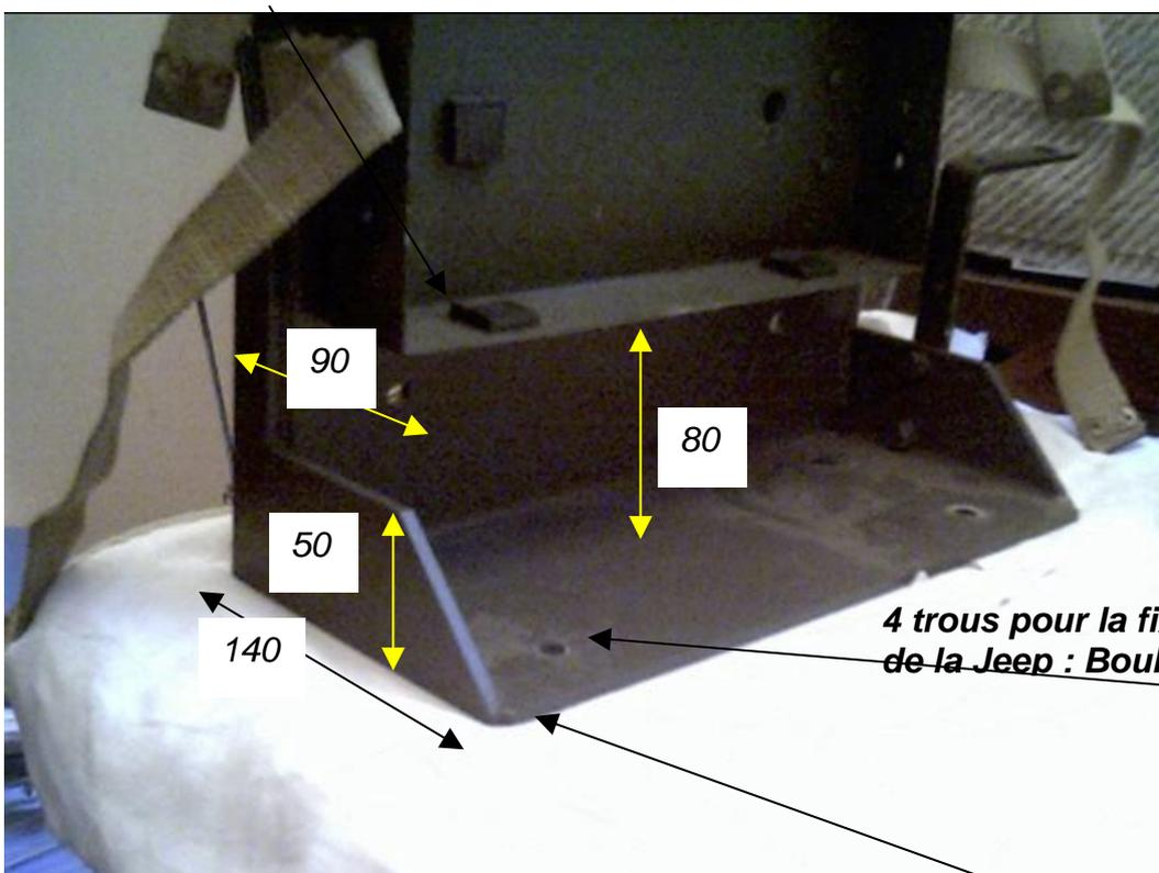
*Tous les angles du "mounting" ou bac sont arrondis entre 3 à 8 mm suivant l'épaisseur de la tôle*
